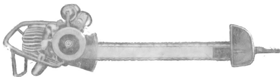
Рис. 1. Моторная пила Rinco A (модель 1927 года)
