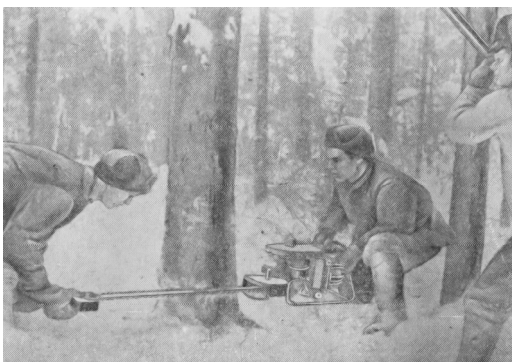
Рис. 6. Валка дерева моторной пилой Rinco A
