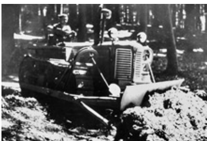
Obr. 4.01 Zemědělský pásový traktor Zetor Super P při úpravě svážnice angledožerskou radlicí. (Archiv autora)
