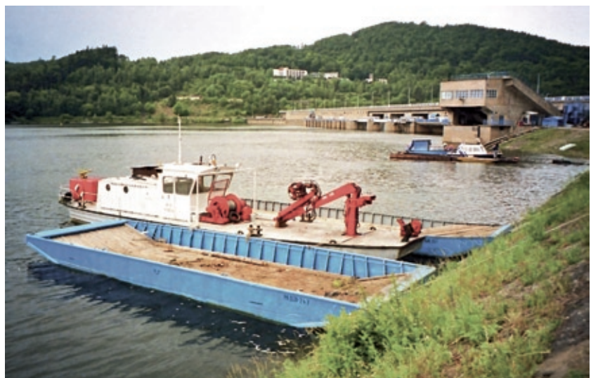
Obr. 3.226 Nyní používaná pracovní loď vybavená hydraulickou rukou s člunem; oba vhodné i pro dopravu dříví, Orlík. (Archiv autora)
