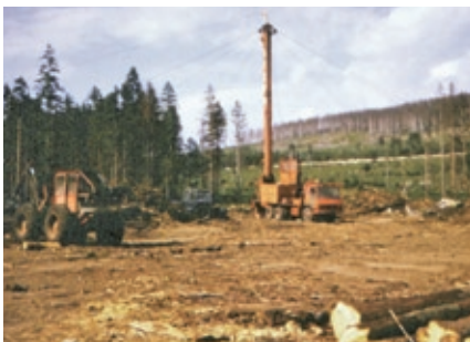
Obr. 3.136 Od 80. let byl dovážen rakouský těžký lanový systém Steyr KSK 16, který sehrál významnou roli v imisních těžbách v Jizerských horách, které nebyly pro explozivní růst těžeb dostatečně zpřístupněné komunikacemi, a nasazení lanového systému pro dlouhé vzdálenosti zamezilo plošné erozi, ke které by jinak při nasazení kolové techniky nutně došlo. (Archiv autora)
