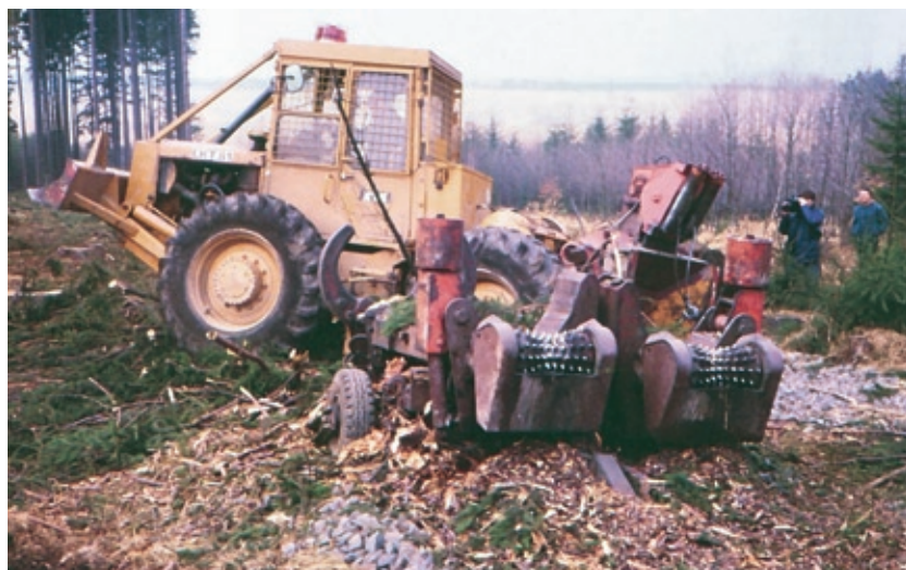
Obr. 3.62 Dvojitý APOS – Dablpos, APOS TWIN, umožňoval efektivní odvětvování i v porostech nižších hmotností, protože protahoval dva stromy současně. (Archiv autora)
