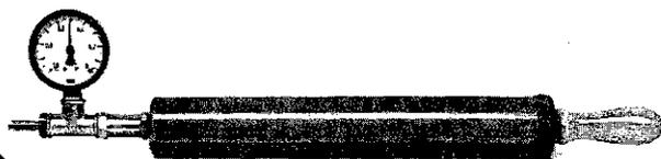
Die Wellendichtringe versagen vornehmlich bei Unterdruck. Beim Saugvorgang des Kolbens hebt dann, wegen des fehlenden Gegendruckes, die Dichtlippe von der Kurbelwelle ab.
