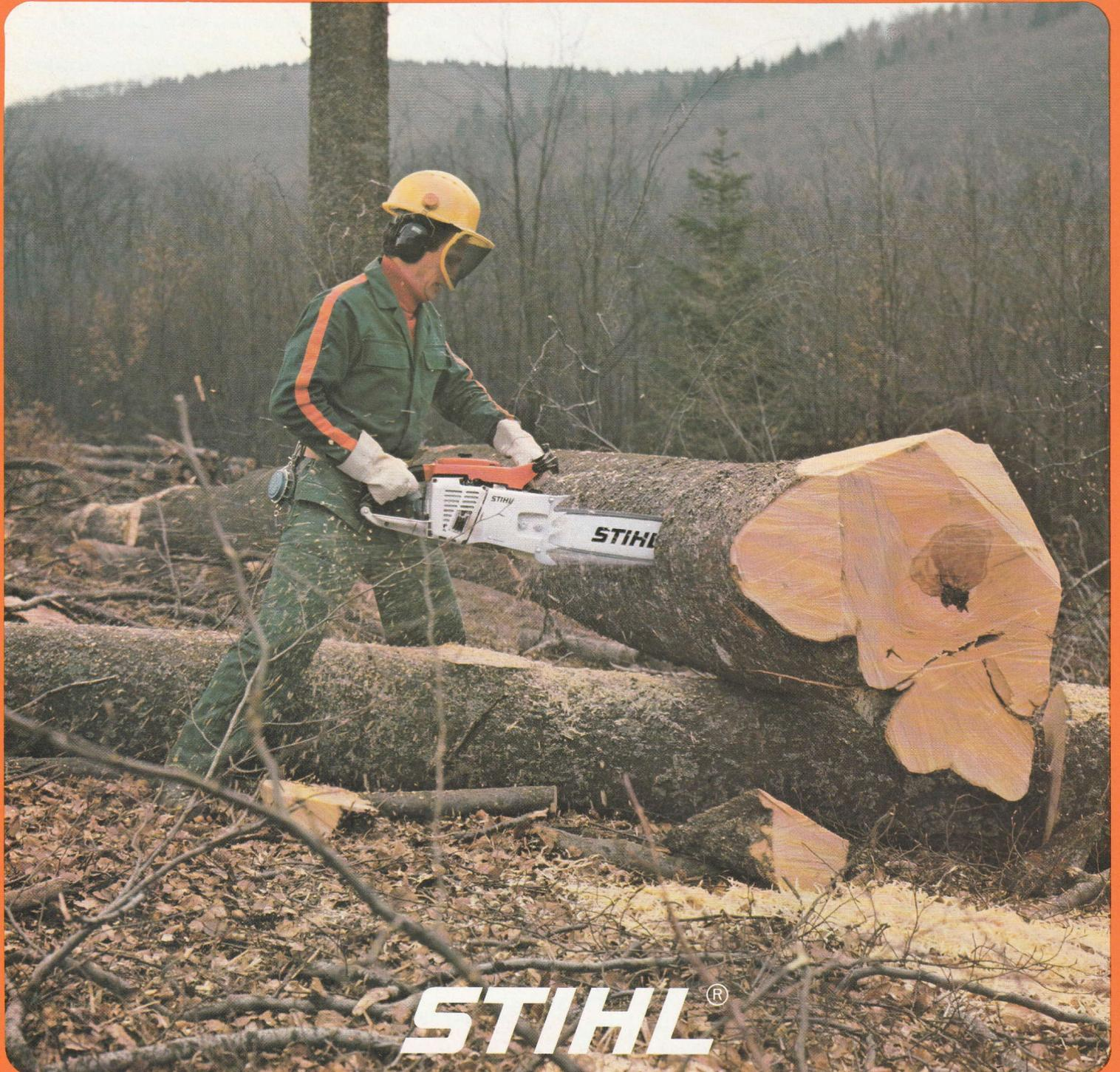
**Unter den starken STIHL-Fällsägen zählt sie sich zu den leichtesten. Ein Kraftpaket, das – mit 43 cm Schneidgarnitur bestückt – lediglich 11,0 kg wiegt. Kein Wunder, daß die STIHL 051 AV electronic seit Jahren eine der beliebtesten Fällsägen ist.**
