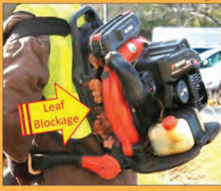
Blower Fan Intake Blockage
