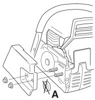
Positionner le guide-chaîne sur les écrous et l'amener à sa position la plus reculée. Placer la chaîne sur le pignon d'entraînement et dans la gorge du guide-chaîne. Commencer par le dessus du guide.
