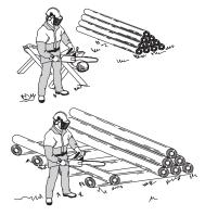
Le tronc est couché à même le sol. Il n'y a aucun risque de coinçage de la chaîne ou de fendage de la pièce à scier. Par contre, il existe un risque important que la chaîne rencontre le sol après le sciage.
