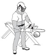
4 Ne jamais se servir de la tronçonneuse à un niveau trop élevé, plus haut que les épaules, et éviter de couper avec la pointe du guide-chaîne. Ne jamais tenir la tronçonneuse d'une seule main!
