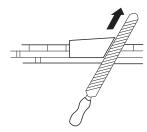
Limer de manière à amener toutes les dents à la même hauteur. Si la hauteur de dent est inférieure à 4 mm (0,16"), la chaîne est usée et doit être remplacée.
