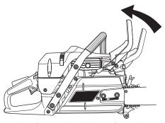
Déposer les écrous du guide-chaîne et le carter d'embrayage (frein de chaîne). Déposer la protection de transport (A).
