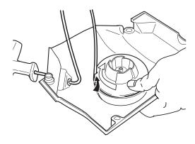
Déposer la vis au centre de la poulie et enlever la poulie. Installer et bloquer une nouvelle corde sur la poulie. Enrouler la corde d'environ 3 tours sur la poulie. Monter la poulie contre le ressort de rappel, de manière à ce que l'extrémité du ressort s'engage dans la poulie. Reposer la vis dans le centre de la poulie. Passer la corde à travers le trou du boîtier du lanceur et dans la poignée. Faire un nœud robuste à l'extrémité de la corde.
