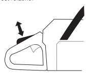
Vérifier que le blocage de l'accélération, la commande d'accélération et leurs ressorts de rappel fonctionnent correctement.
