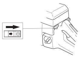
Le moteur s'arrête lorsque l'on coupe l'allumage en pressant sur le bouton d'arrêt.
