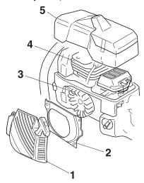
Nettoyer le système de refroidissement avec une brosse une fois par semaine, voire plus souvent dans des conditions difficiles. Un système de refroidissement sale ou colmaté provoque la surchauffe de la machine, endommageant le cylindre et le piston.
