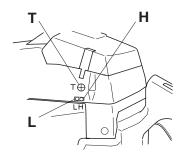
Les pointeaux L et H règlent le débit de carburant nécessaire par rapport au flux d'air permis par l'ouverture de la commande de l'accélération. S'ils sont tournés dans le sens des aiguilles d'une montre, le mélange est plus pauvre (moins d'essence); s'ils sont tournés dans le sens contraire des aiguilles d'une
