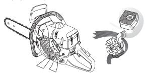
IMPORTANT! L'épuration centrifuge exige un entretien correct et continu de la machine. Nettoyer la prise d'air du lanceur, les ailettes du ventilateur, le compartiment du volant, le tuyau d'admission et le compartiment du carburateur.
