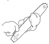
Vérifier que le pignon du nez tourne librement et que l'orifice de graissage est propre. Nettoyer et graisser au besoin.
