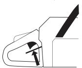
Appuyer sur le blocage de l'accélération et vérifier qu'il revient de lui-même en position initiale quand il est relâché.
