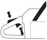
Mettre la tronçonneuse en marche et accélérer au maximum. Lâcher la commande de l'accélération et s'assurer que la chaîne s'arrête et demeure immobile. Si elle tourne quand la commande est en position de ralenti, il convient de contrôler le réglage du ralenti du carburateur.
