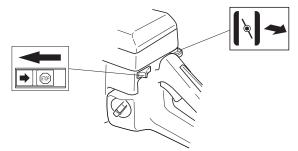
Si la machine est équipée d'un décompresseur (A): enfoncer celui-ci pour réduire la pression dans le cylindre et faciliter le démarrage de la machine. Toujours utiliser le décompresseur au démarrage. Une fois le moteur lancé, le décompresseur se remet automatiquement en position initiale.
