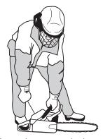
Enfoncer la commande de starter dès que le moteur s'emballe et rèpèter les lancements jusqu'au dèmarrage. Dès que le moteur dèmarre, appuyer et relâcher
