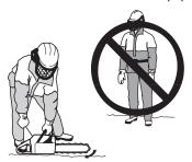
Tenez toujours la tronçonneuse à deux mains. Tenez la main droite sur la poignée arrière et la main gauche sur la poignée avant. Tous les utilisateurs, droitiers et gauchers, doivent la tenir ainsi. Tenez fermement en entourant la poignée de la tronçonneuse avec les pouces et les autres doigts.
