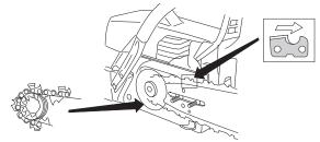
S'assurer que la face tranchante des dents est vers l'avant sur le dessus du guide.
