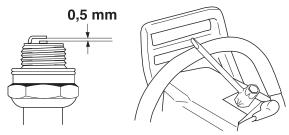
Remarque! Toujours utiliser le type de bougie recommandé! Une bougie incorrecte peut endommager le piston/le cylindre.
