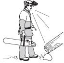
5 Observer la plus grande prudence lors de l'abattage des arbres sous tension. Avant et après le sciage, les arbres sous tension risquent de brutalement retrouver leur position initiale. Un mauvais placement de l'utilisateur ou de l'entaille d'abattage peut entraîner un choc avec l'arbre pouvant résulter en une chute ou en une perte du contrôle de la machine. Ces deux cas
