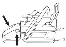
Remarque! Tirer l'arceau protecteur vers la poignèe avant. Le frein de chaîne est alors libèrè. La tronçonneuse est maintenant prête à être utilisée.
