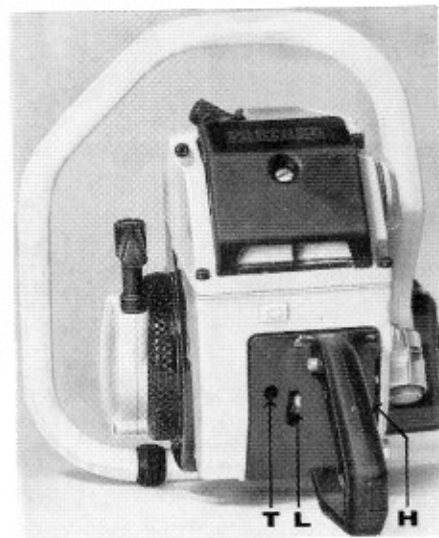
Fig 14. H=hål till justerskruv för högvarvmunstycke, L=hål till justerskruv för lågvarvmunstycket, T=hål till tomgångsskruv
