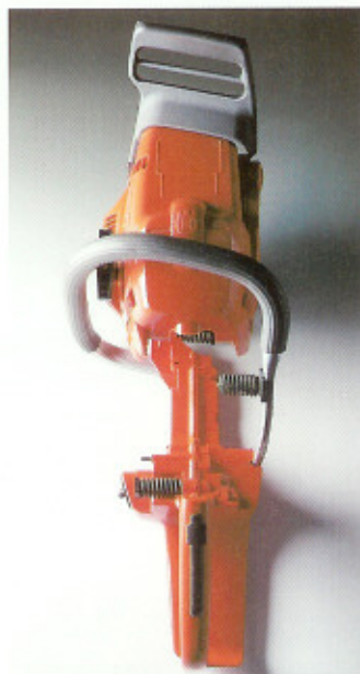
Tvämasseprincipen. Handtagen och bränsletanken är separerade från motorn med spiralfjädrar av stål, vilket ger extremt låga vibrationer. Tröghetsutlöst kedjebroms med dubbellagrad kastskyddsbygel.
