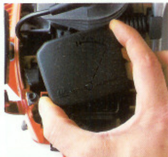
Luftfilter med bajonettfattning gör filtret lätt att ta loss för rengöring.
