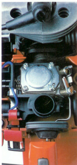
Dämpelament av gummi mellan förgasare och vevhus minskar vibrationerna i förgasaren. Det ger en mer harmonisk gång och längre livslängd.
