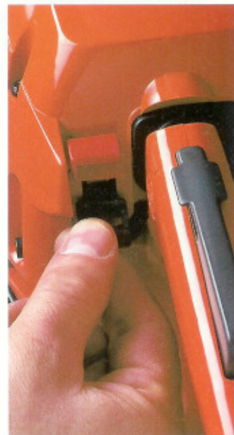
Kombinerat choke/stoppreglage som gör sågen enklare att starta och stoppa. Vid chokning ställs stoppknappen automatiskt i körläge.
