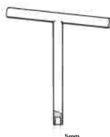
50 25 020-01 (M5) Stud fitting tool
