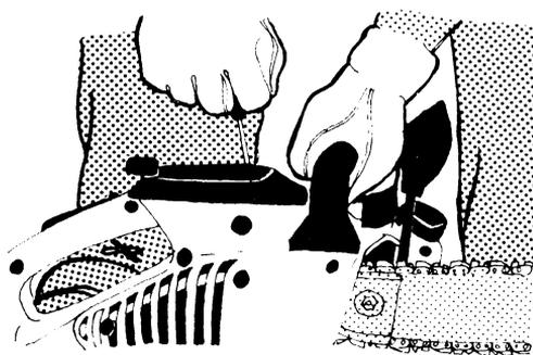
**5.** Repousser le levier en position "RUN" en accélérant lentement. Si nécessaire tirer le lanceur pour redémarrer le moteur.
