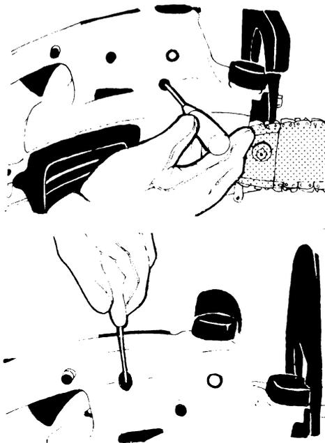
**1.** Règlage vis dosage minimum (16). Moteur arrêté visser à fond sans forcer la vis. Dévisser d'1 tour 1/4.
