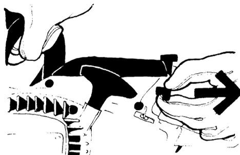
**3.** Si le moteur est chaud le démarrage s'effectue sans pousser le levier du starter en position "START".
