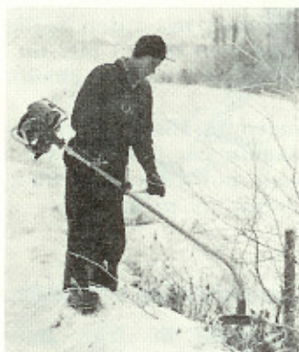
Buskröjningsaggregat Homelite Modell BC i praktiskt arbete
